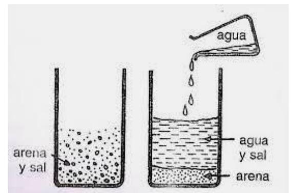
c.- **FILTRACIÓN Y EVAPORACIÓN** Consiste en filtrar el componente disuelto en el punto anterior y recuperarlo (arena y agua salada). Al filtrar, pasa el agua salada a través del filtro y queda la arena retenida en éste. Luego se evapora el agua quedando la sal en estado sólido en el fondo del recipiente.
